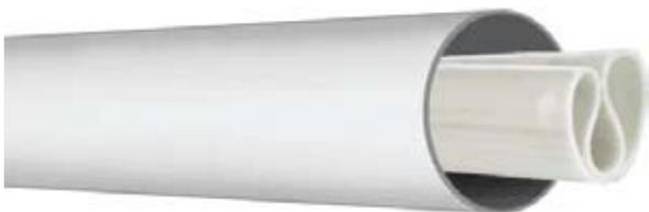
**Mandals Tube In** — это крепкий круглотканый шланг, экструдированный гибким полиэтиленом (PE), который предназначен для ремонта напорных труб для питьевой воды. Тканый каркас изготавливается из очень крепкой синтетической комплексной нити и покрывается изнутри и снаружи гибким полиэтиленом при помощи технологии «extrusion through the weave», что обеспечивает очень хорошее сцепление каркаса с PE-материалом, и каркас также надежно герметизируется между слоями покрытия.
